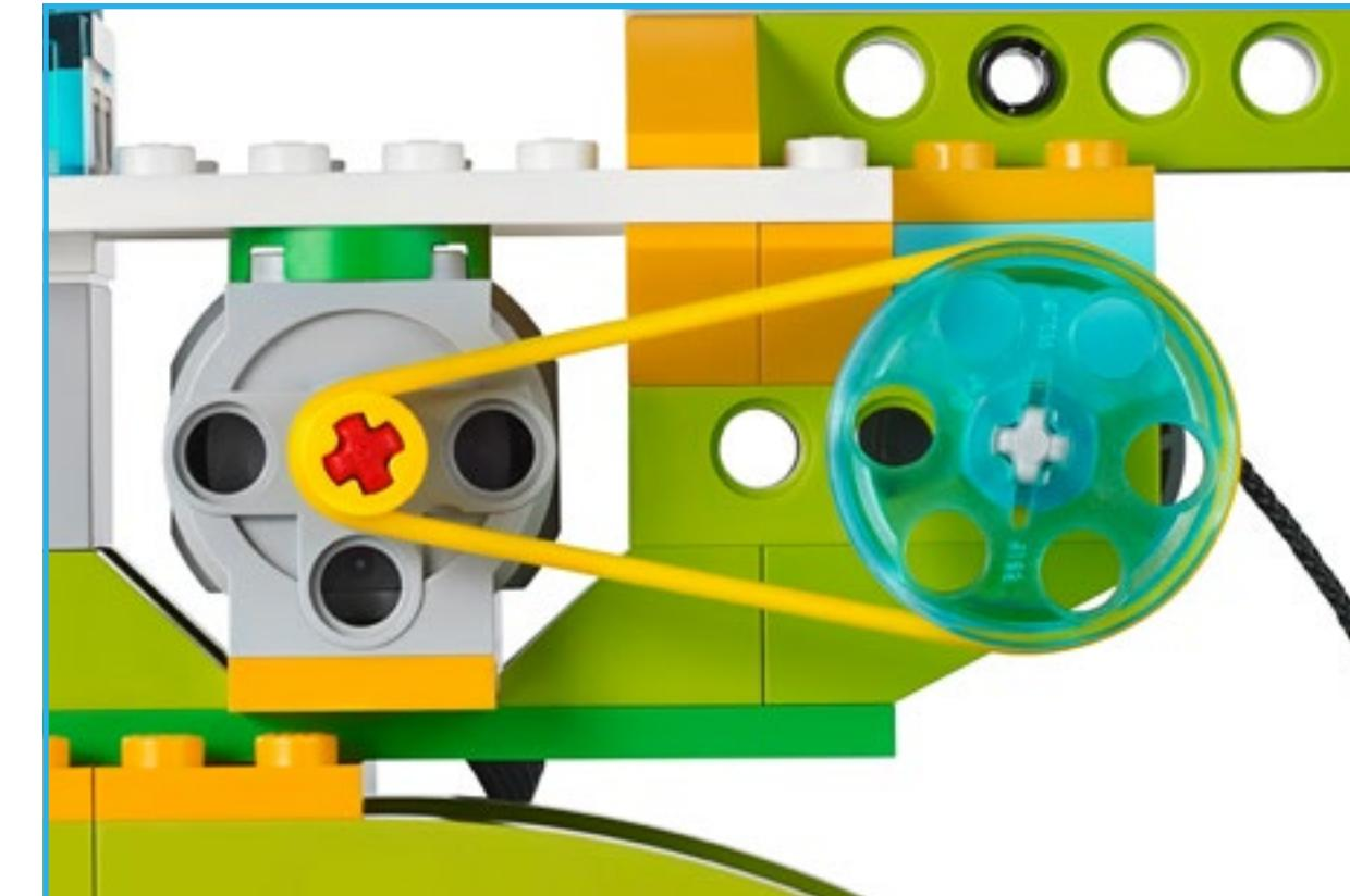
**Übersetzung:** Eine größere Rolle treibt eine kleinere an. Die Drehgeschwindigkeit der angetriebenen Rolle wird gesteigert, dabei wird jedoch auch gleichzeitig ihre Kraft – die Kraft, mit der die angetriebene Rolle etwas drehen kann – reduziert.
