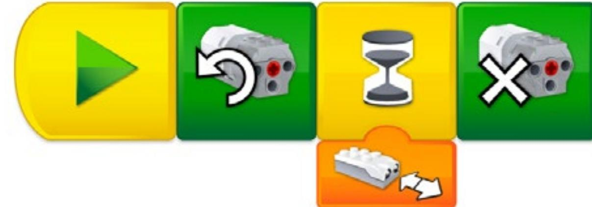
Dieses Programm kann auch beim Neigungssensor oder beim Geräuschsensor eingesetzt werden. Da muss nur der Eingabeblock entsprechend ausgetauscht werden.
