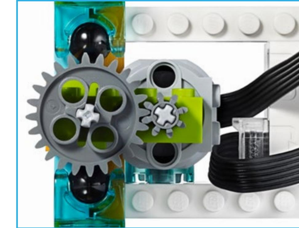
**Übersetzung:** Ein größeres Zahnrad treibt ein kleineres an. Die Drehgeschwindigkeit des angetriebenen Zahnrads wird gesteigert, dabei wird jedoch gleichzeitig seine Kraft – die Kraft, mit der das angetriebene Zahnrad etwas drehen kann – reduziert.
